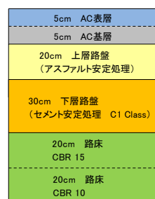
図 3-4 本計画の舗装構造
