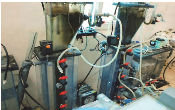
同プラントの廃水処理ラボスケールリアクター
