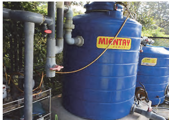
RRIVの廃水処理システムの パイロットスケールリアクター
