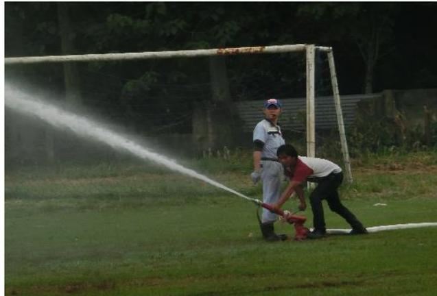
図 2-7 固定した噴射ノズル
