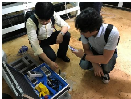
ホテルEの浄化槽内部でpH検査
