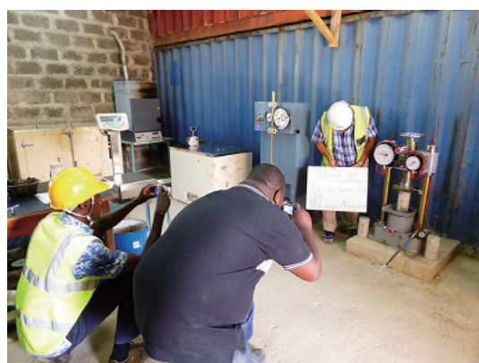
24 施工業者の試験室内でのコンクリート圧縮試験への立会い状況
