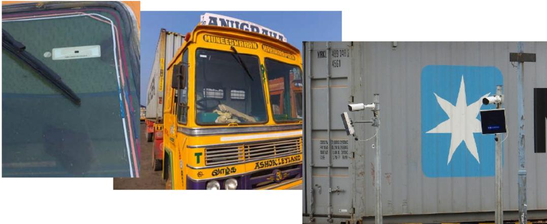
ChPTは関係者の協力を得て、RFID(Radio Frequency Identification)システムを導入した。これはコンテナ搬送トレーラにタグを取り付け、CFS/ChPT/ターミナル間で情報の共有を図ることにより、効率的な貨物管理と迅速なゲート運営を実現しようとするものである。これにより得られる情報の積極的な活用方法をChPT等関係者に継続的に提案した。
