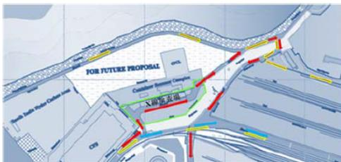
港内を3地区に分け、それぞれの地区での交通流の問題点・解決策を指摘した。特にX線検査場付近の混雑回避のため、輸入動線上へのX線検査場設置を提案した。ChPTは新検査装置導入の予算申請を行っている。
