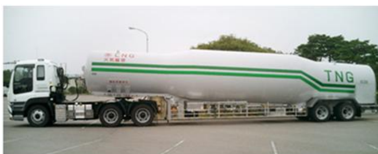
Figure 6.4-4 LNG Tank Truck (15.1 tonne)
