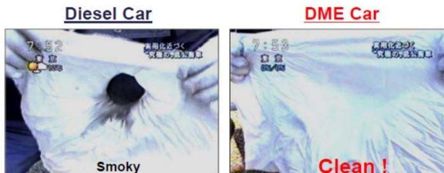
図 5.1-17 排気ガスの比較 (ディーゼル車と DME 車)
