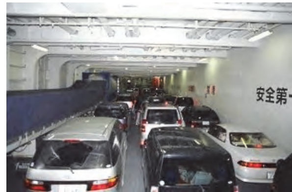
参考：日本国内のカーフェリー 車両の搭載：十分な車間間隔をとり、固縛する。
