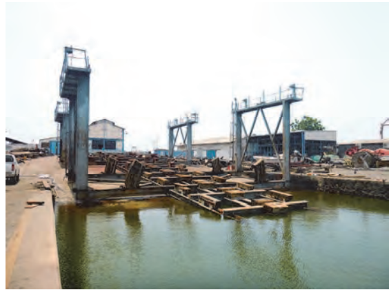
上架スリップウェイ 最大上架能力：全長 50m
