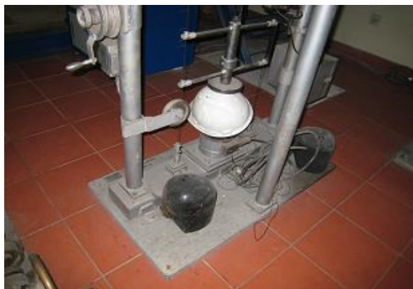
インドネシア Pusat K3 (労働安全衛生センター) No.7 研修棟内(ヘルメット強度計測機材)
