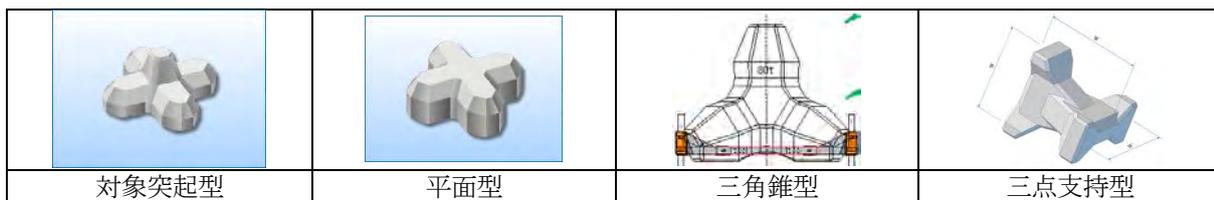
図 5.1.16 根固めブロックのタイプ
