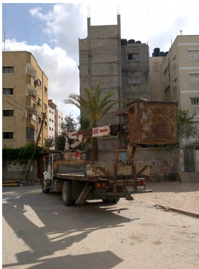
図 3-8 GEDCO の高所作業車 (GEDCO North Branch)
