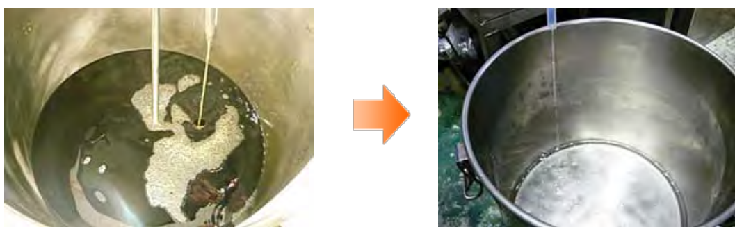
図 2-1 使用済み廃有機溶剤（左）とリサイクルされた有機溶剤（右）
