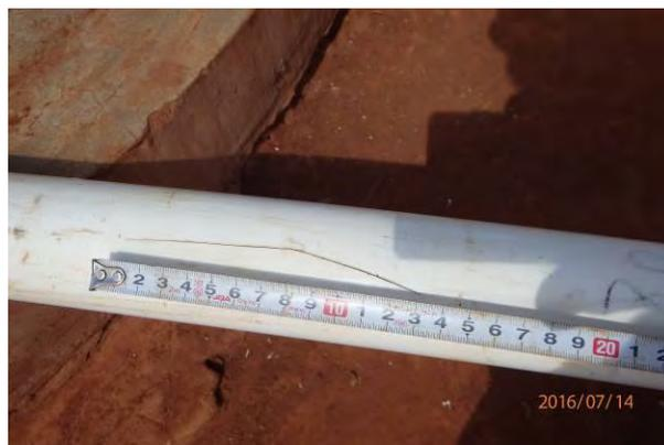
Depois de medir o nível da água no interior do tubo e verificar que a válvula de pé não apresentava nenhum problema, retirou-se o tubo de elevação. Foi constatada rachadura de 14 cm de comprimento à altura do nível da água medida anteriormente.
