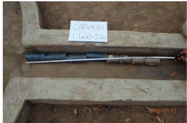
Tubo de elevação de PVC, cortado para ser retirado do furo.
