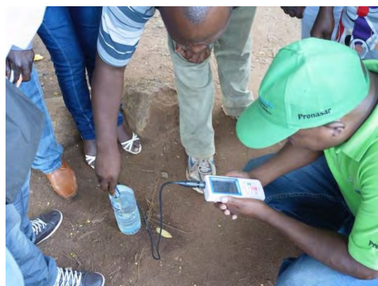
第2回 PEC 研修の中で水質について 特別講義で pH を測定する研修生。 (2013年12月20日、マンディンバ郡)
