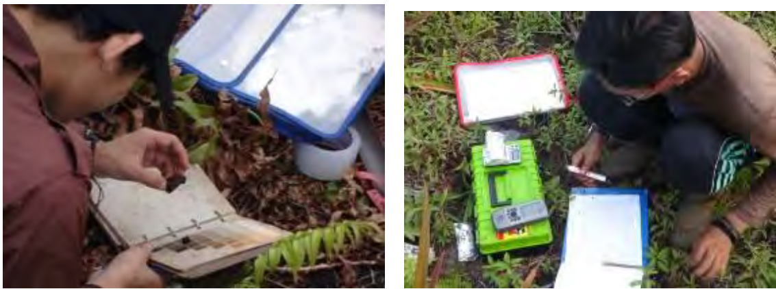
Gambar 22 Survey Verifikasi di lapangan (Kiri: Observasi warna, Kanan: Pengukuran kerapatan curah)
