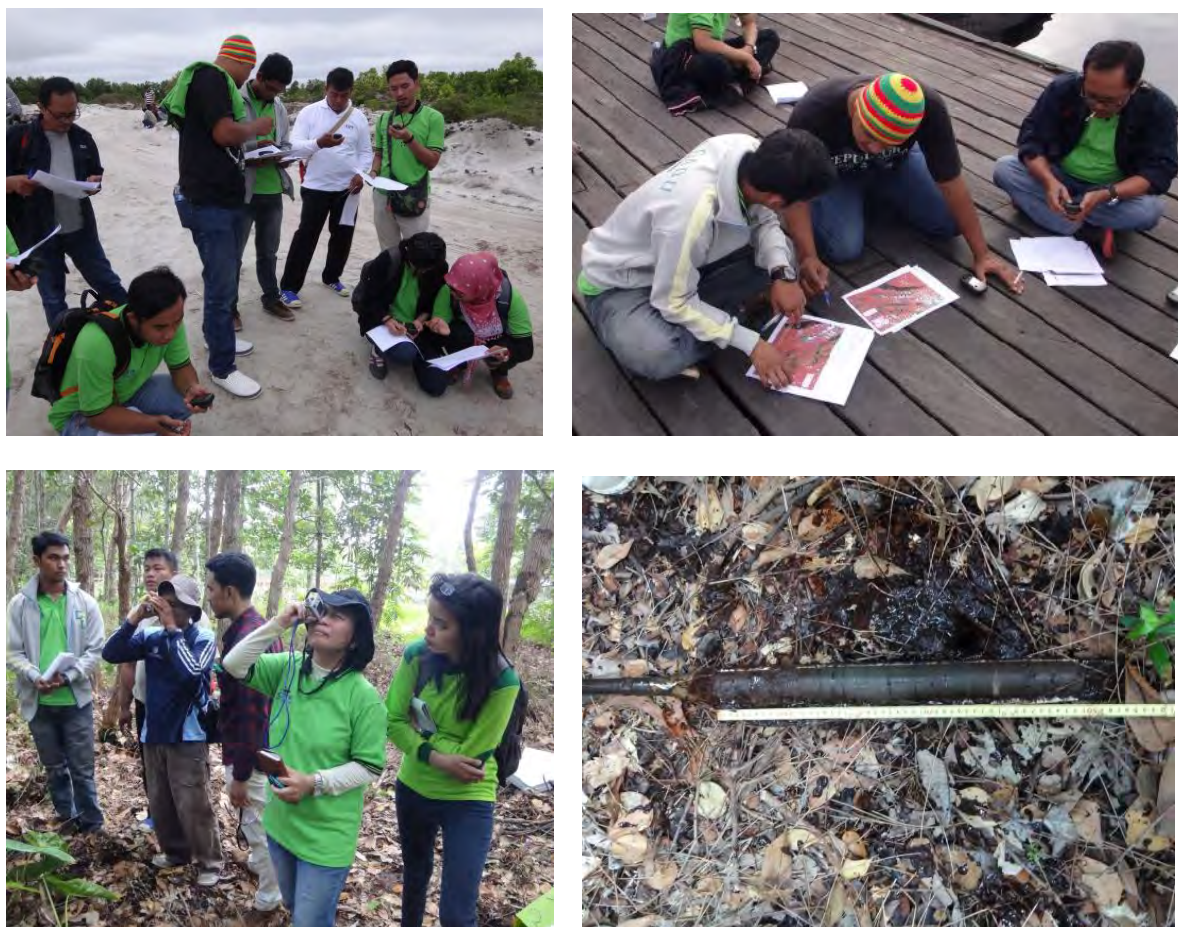
GPS を用いた位置情報の取得/記録 (左上)、衛星画像と現地の状況の比較 (右上) Vertex を用いた泥炭湿地林の高さ測定 (左下)、泥炭の観察用コア (右下)
