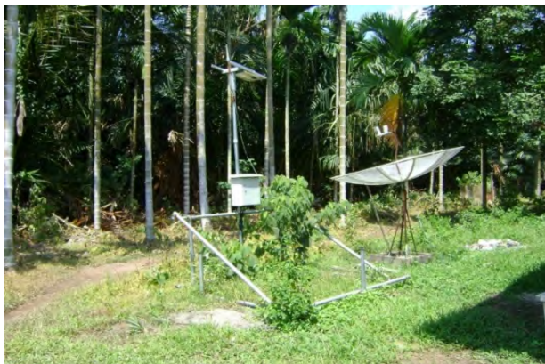
テレメトリー方式泥炭地水位モニタリング装置BPPT製MORPALAGA（Riau州Meranti県Tebing Tinggi Timu郡, Des.S.Tohor村郡長事務所宿泊所Sanggar Seni;2017年7月17日）
