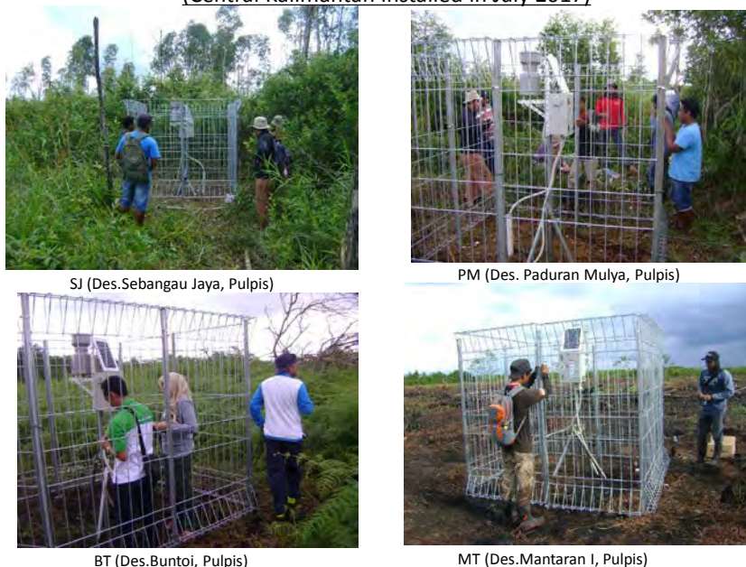
図 2.5.2.2 中央カリマンタン州（新設）泥炭水位測定装置の概観
