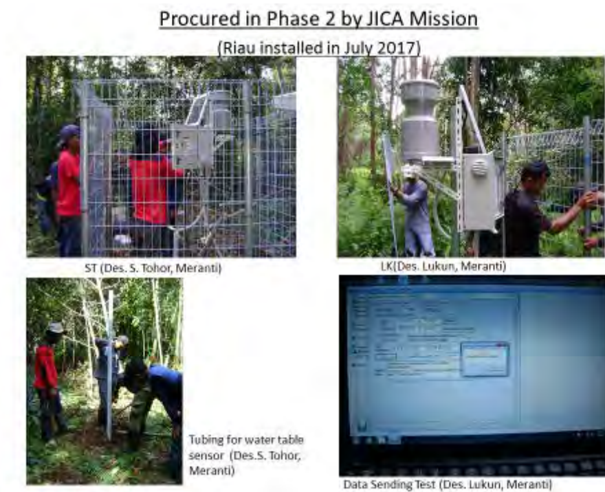
図 2.5.2.3 リアウ州（新設）泥炭水位測定装置の概観
