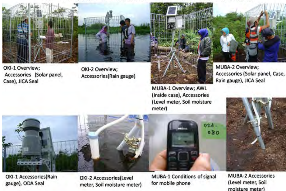
図 6.2.1.4. 2016年12月設置の泥炭地モニタリング装置の概観
