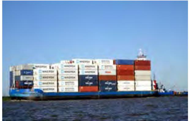
写真 6-4：パラグアイ川沿岸にある港湾荷役設備の能力制限の為、20 フィートコンテナが大半。
