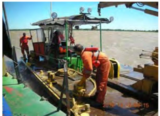
写真 5-2：浚渫船スイング用アンカーや水上排泥管固定用アンカーの打替え作業等を行う TSC 社のムラ（雌ロバの意味）と呼ばれる作業支援船。
