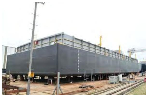
写真 3-18 : チャコ造船所で建造中の 3,000DWTばら積みバージ。
