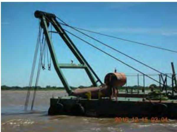
写真 5-1：MOPC の民間委託業者 TSC が所有する浚渫船の船首部にあるラダーを吊り下げるための A 型フレーム。
