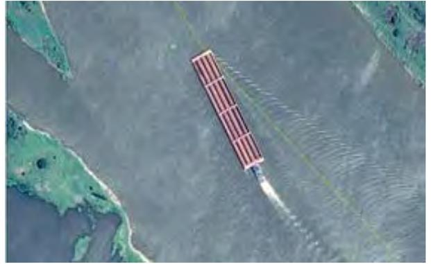
写真 6-2：ばら積み（バルク）バージの船団（コンボイ）。60m x 15mのバージ 16 隻を 4 x 4 列に組んで 1 隻のプッシャーで押している。
