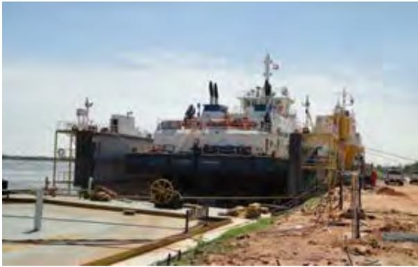
写真 3-9：ラ・バルカ造船所では、船舶修繕用にフローティングドックを2基保有。リフティング能力は夫々2,000 トンと 1,500 トン。
