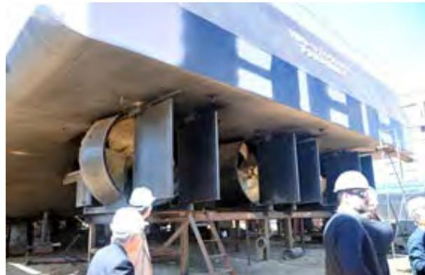
写真 3-8 : 浅喫水の為 2,000 馬力 3 基のエンジンを横に並べて 3 個のダクトプロペラを駆動。舵は前後進用にプロペラの前後に 2 枚ずつ配置。
