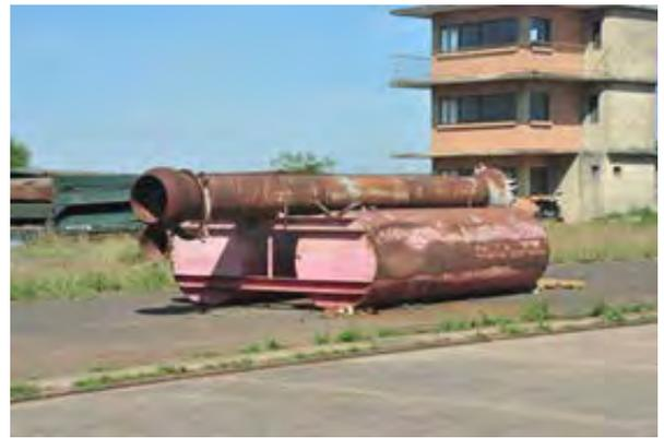
写真 2-6: 同じく Villeta 港の岸壁で点検中の水上排泥管とそれを支えるフローター。排泥管の左端に見えるのが連結用ボールジョイント。
