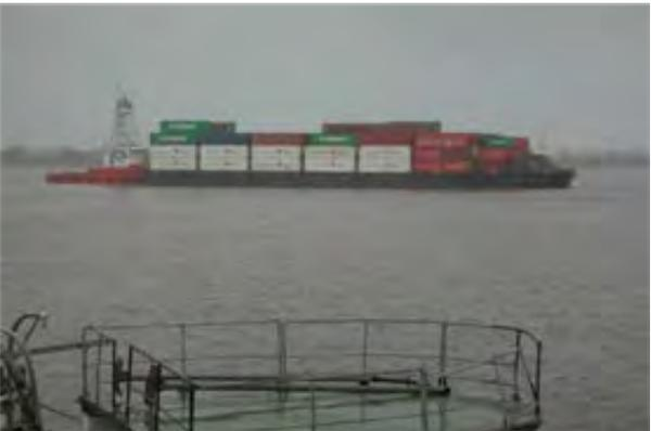
写真 6-3：パラグアイ川をプッシャーに押されて航行するコンテナ搭載バージ船団。
