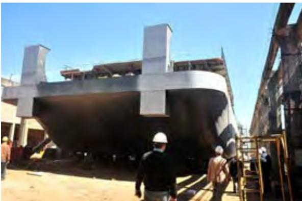
写真 3-7 : ラ・バルカ造船所で建造中の 6,000 馬力プッシャー。
