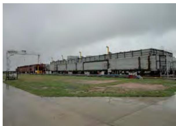
写真 3-2: ATP 構内で連続建造中の 3,000DWT ばら積みバージ。河川航行に適した平底の浅喫水型。
