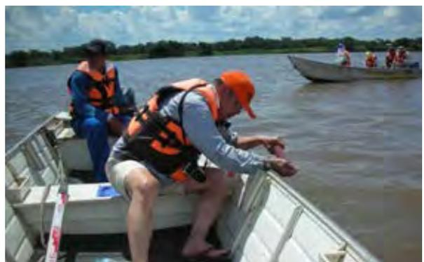
写真 4-2 : 各難所では、チャーター船に搭載した小型ボート 2 隻を使って、流速、水温（表面及び水深 1m）、底質調査を実施。
