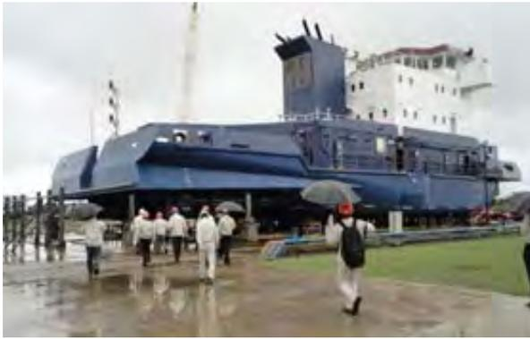
写真 3-3 : ATP 構内で建造中の 6,000 馬力プッシャー (押船)。浅喫水型の為、1,500 馬力エンジンを 4 基並べて、4 個のプロペラを駆動。
