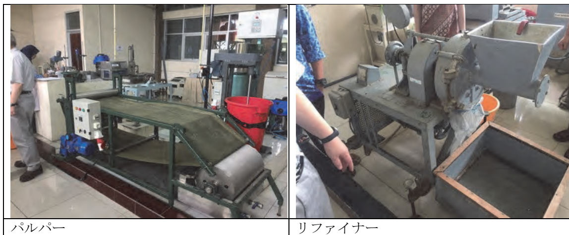
写真 3 CPPが所有するパルプ製造機器
