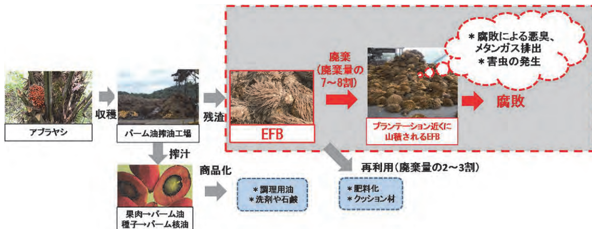
図 8 パーム油搾油工程におけるEFB廃棄物の流れ
