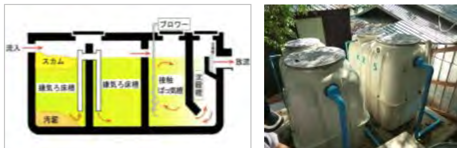
図 1-2 浄化槽の仕組み
