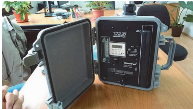
写真 7-2-15 ミニポリウムエアサンプラー (Air Metrics)
