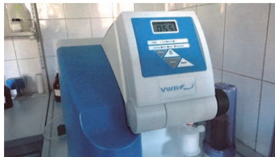
写真 7-2-16 純水製造装置 VWR
