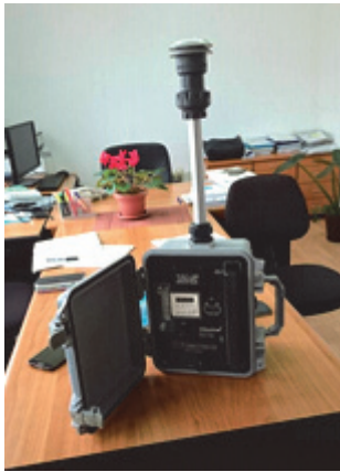
写真 7-2-15 ミニポリウムエアサンプラー (Air Metrics)
