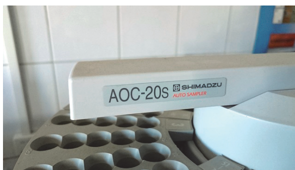
写真 7-2-4 オートサンプラー、Shimadzu AOC-20s
