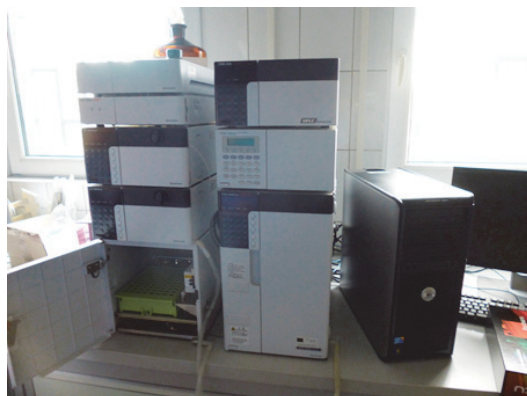
写真 7-2-11 IC (Shimadzu HIC-20A super、検出器 CDD-10A sp)
