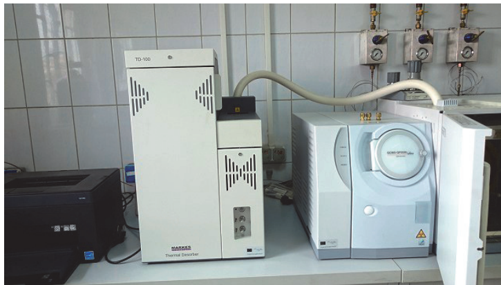
写真7-2-6 熱脱着装置 TD-100 (左) と GC-MS の接続
