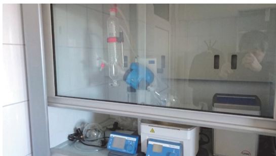
写真 7-2-14 ロータリーエバポレータ
