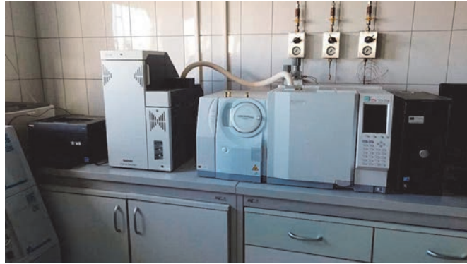
写真7-2-5 Gas-MASS, Shimadzu GC-2010 Ultra (右)、熱脱着装置 TD-100 (左)
