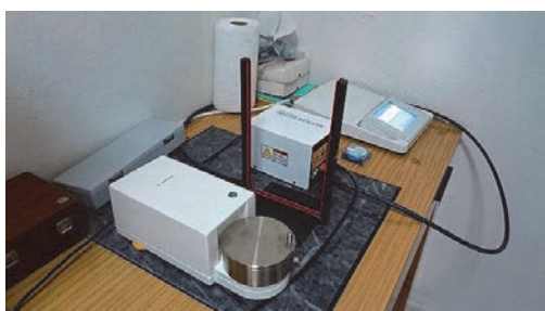
写真 7-2-2 超高精度電子天秤 Sartorius
