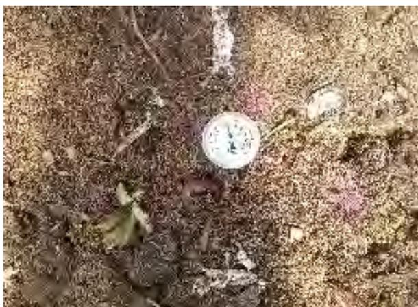
⑬発酵床の温度計測
