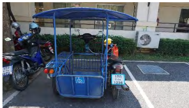
自動二輪車改造した車イスのままで操作できる移動車
