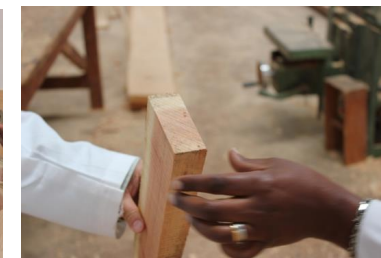
2方柱の試験体、この後天乾
