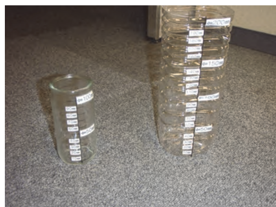
Fig. 11 Simple rain gauge
