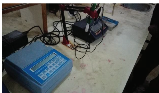
写真 4-①-b 水質分析機材 (多項目水質分析器と pH 計)
