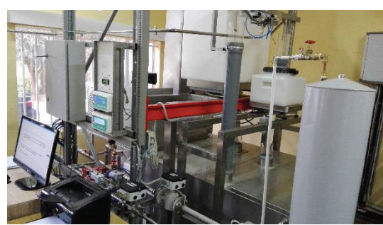
写真 4-②-b 水道メーター・テストベンチ (操作部)
