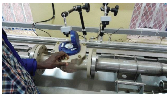
写真 4-②-a 水道メーター・テストベンチ
