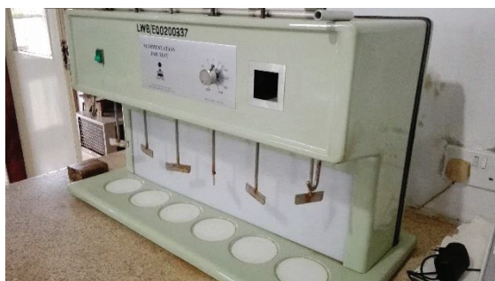
写真 4-①-c 水質分析機材 (ジャーテスター)
