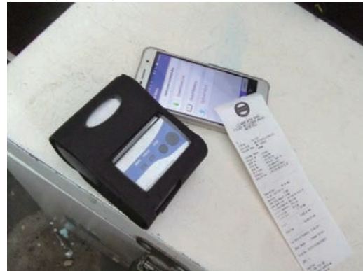
2016年10月から導入されたオンサイト・モバイル請求システムでは、メーター検針員はスマートフォン上でメーターのデータを入力し、その場で顧客に請求書発行ができる。
