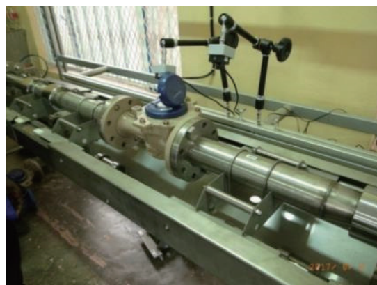
写真-3.12-5 テストベンチ② (口径 50mm~89mm 用)
