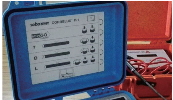
リロングウェ水公社が所有する相関式漏水探知機。2012年に欧州投資銀行の支援事業により1台購入した。
