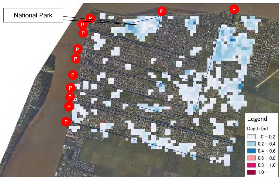
図 R 3.3.4 洪水解析結果（ケース 3：将来の目標）（浸水面積：8.8km 2 ）
