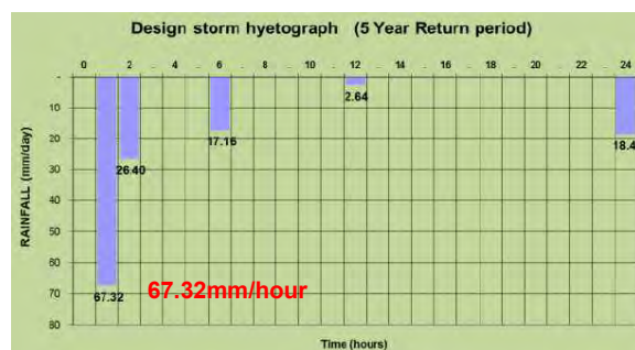
図 R 3.1.9 5年確率降雨におけるハイエトグラフ（NDIA 報告書（2015））
