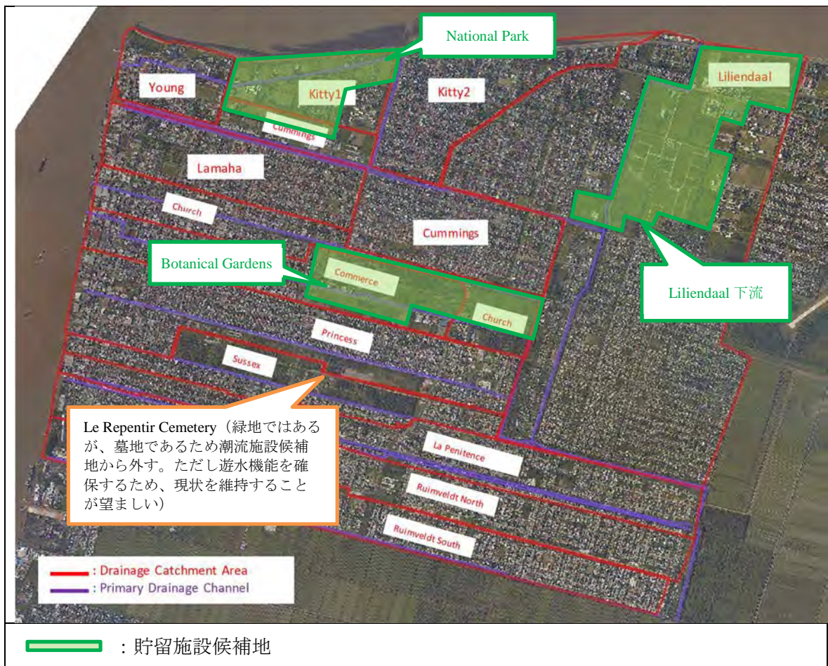
図 R 3.1.14 ジョージタウン市における主要な貯留施設候補地
