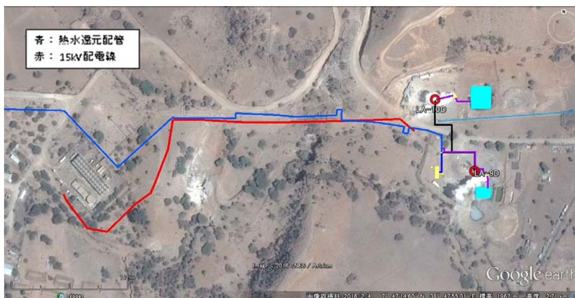
図 3-2-2.2 熱水還元配管と配電線の概略ルート (LA-9D からパイロットプラントまで)
