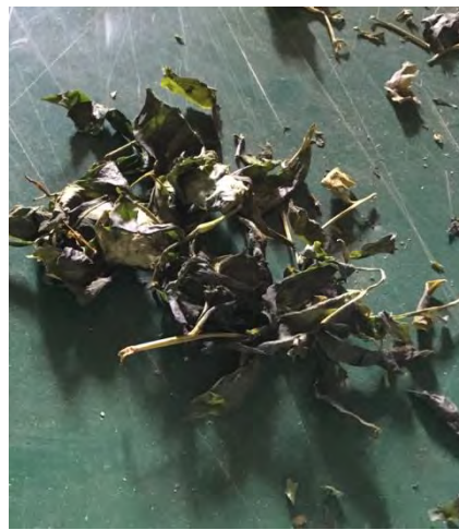
図 2-4-1.12 攪拌冷却後も水分が多く、お互いに付着した茶葉及び乾燥機で焦げた茶葉
