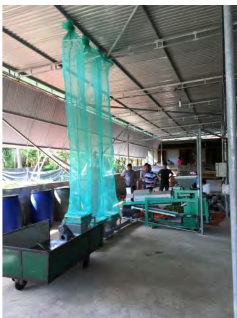
【新設した蒸機及び露払機】
