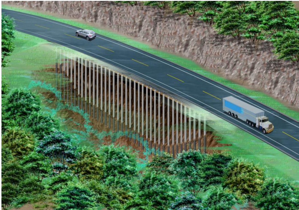
Est. 22b-1 Contramedidas al deslizamiento presentación de obras.
