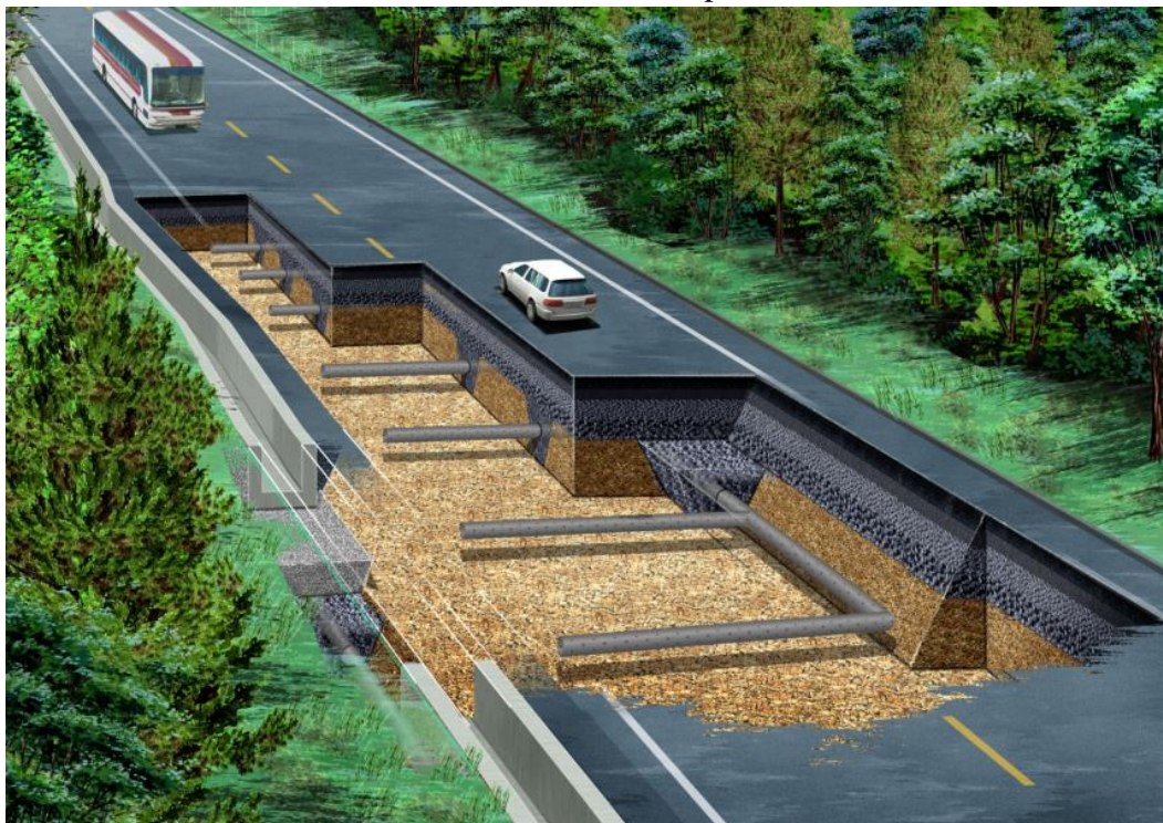
Est. 22a Contramedidas al deslizamiento presentación de obras.
