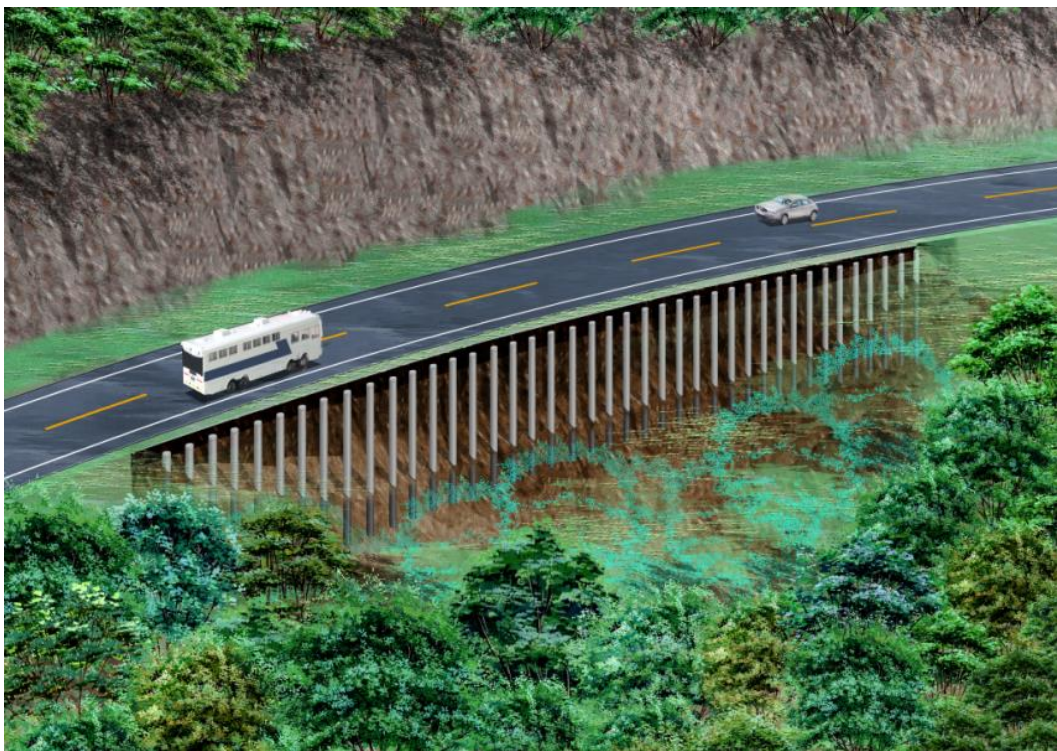
Est. 22b-2 Contramedidas al deslizamiento presentación de obras.
