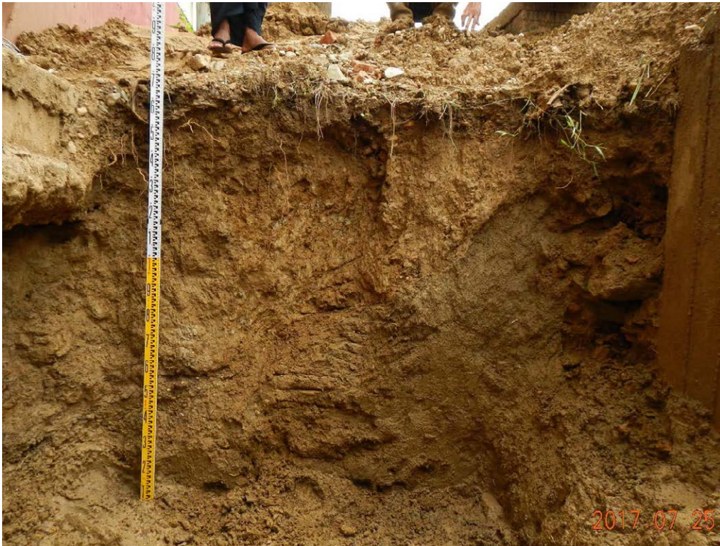
写真：ピット掘削断面状況
