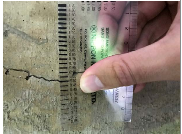
箇所1 クラック幅 最大 0.5mm
