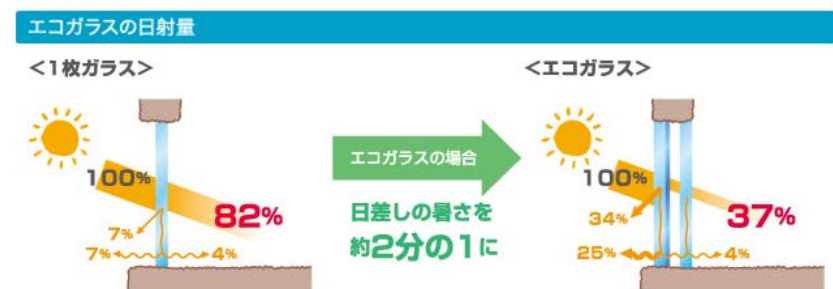
図 2-4 1 枚ガラス（左）と省エネガラス（右）の透過日射量の比較
