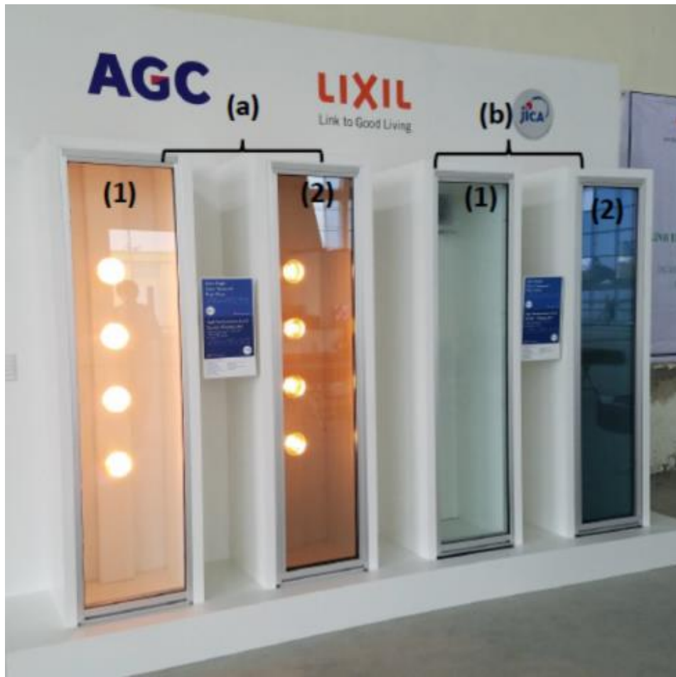
図 6-8 体感器（設置場所： ハノイ市省エネルギーセンター研修センター） (a) 遮熱効果確認、(b)結露防止効果確認（いずれも(1)ref(1枚ガラス)、(2)Low-E 複層ガラス）
