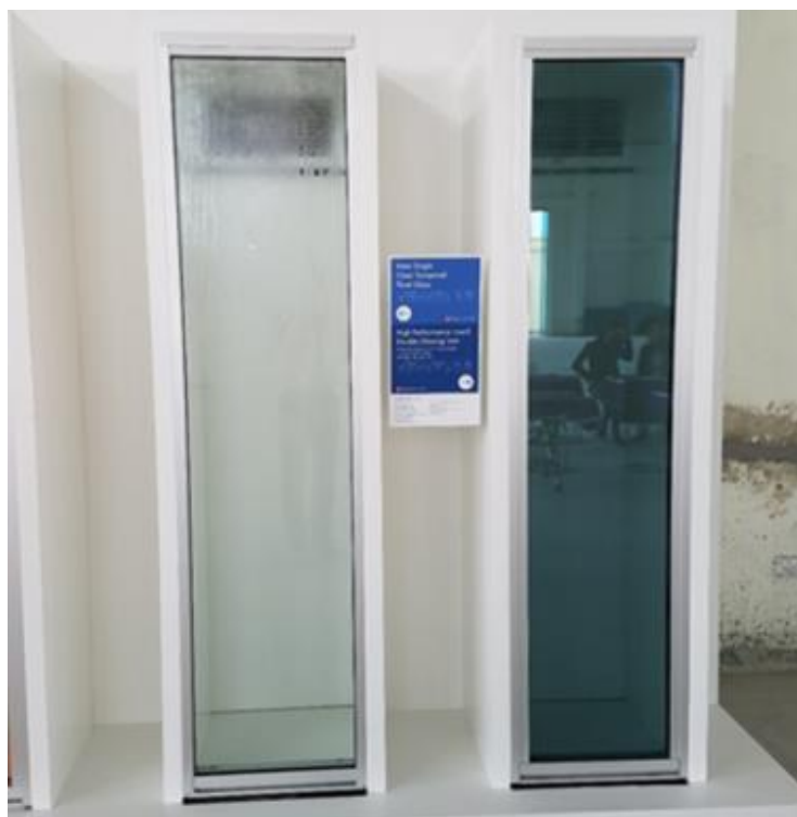
図 6-9 体感器、結露防止効果確認 (いずれも(1)ref(1枚ガラス)、(2)Low-E 複層ガラス)
