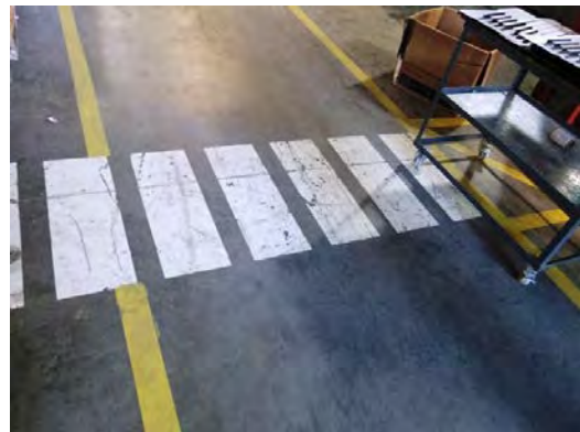
作業スペースと安全通路（安全徹底）
