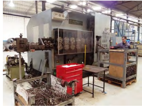
ほぼ自動化されたライン (鋼材原料が巻いてあるタイプはそのまま コイルを製造) (コールド加工タイプ)
