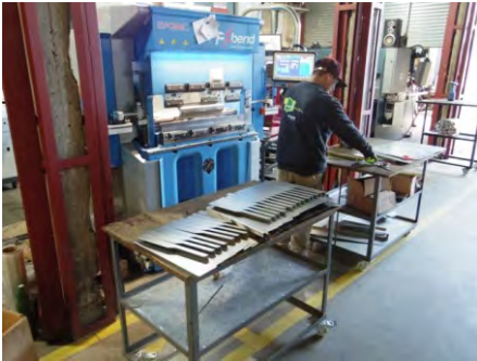
金属加工機械（ジェネレーターカバー等の金属を切ったり折り曲げる機械）
