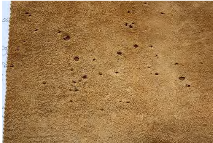
図 3.2.13 寄生虫による皮の傷（ハエの一種の幼虫による穿孔が原因）
