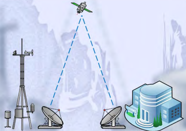
既設VSAT衛星通信システム
