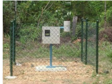
Automatic Rain Gauge (NBRO and ITI)
