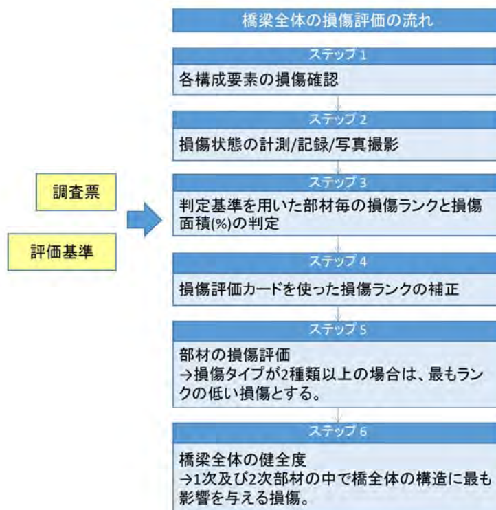
図 II-38 橋梁全体の健全度評価フロー
