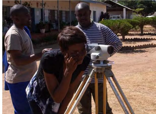
**ダンピーレベルを用いた測量実習**：TSB 職員を対象にした測量実習。短期大学等で学んだ者も多いが、しばらく実践していないので、良き復習となった。
