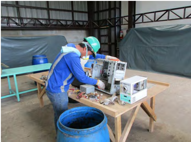
(c) オペレーションスタッフによる手解体
