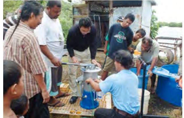
宮城県の株式会社いちごホールディングスは、ミクロネシアに移動式の小型飲料水造水システムを導入。海水を淡水化して安全な飲料水の供給を目指す
