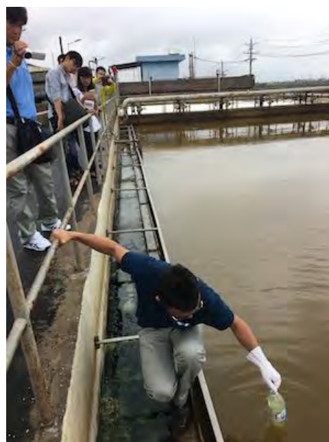
ファンティエット工業発展センター共同排水処理場で採水
