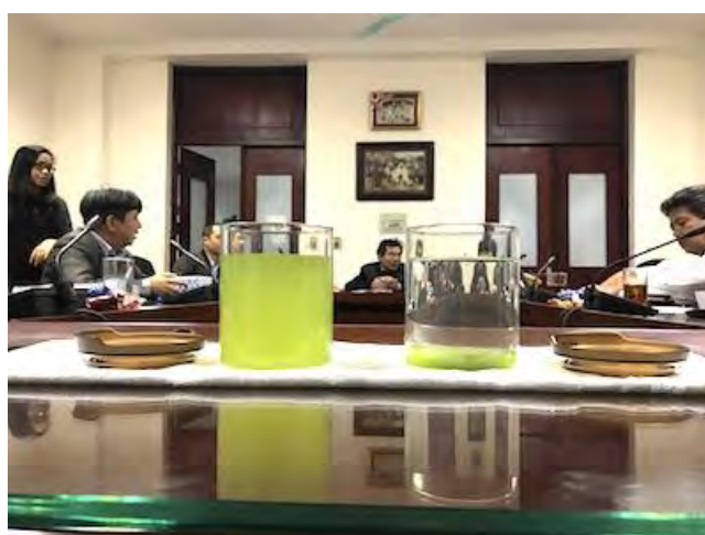
凝集沈殿の実演。右側がルミライト粉を入れた状態
