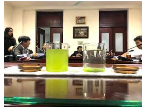
環境技術研究所凝集沈殿の実演 右側がルミライト粉を入れた状態
