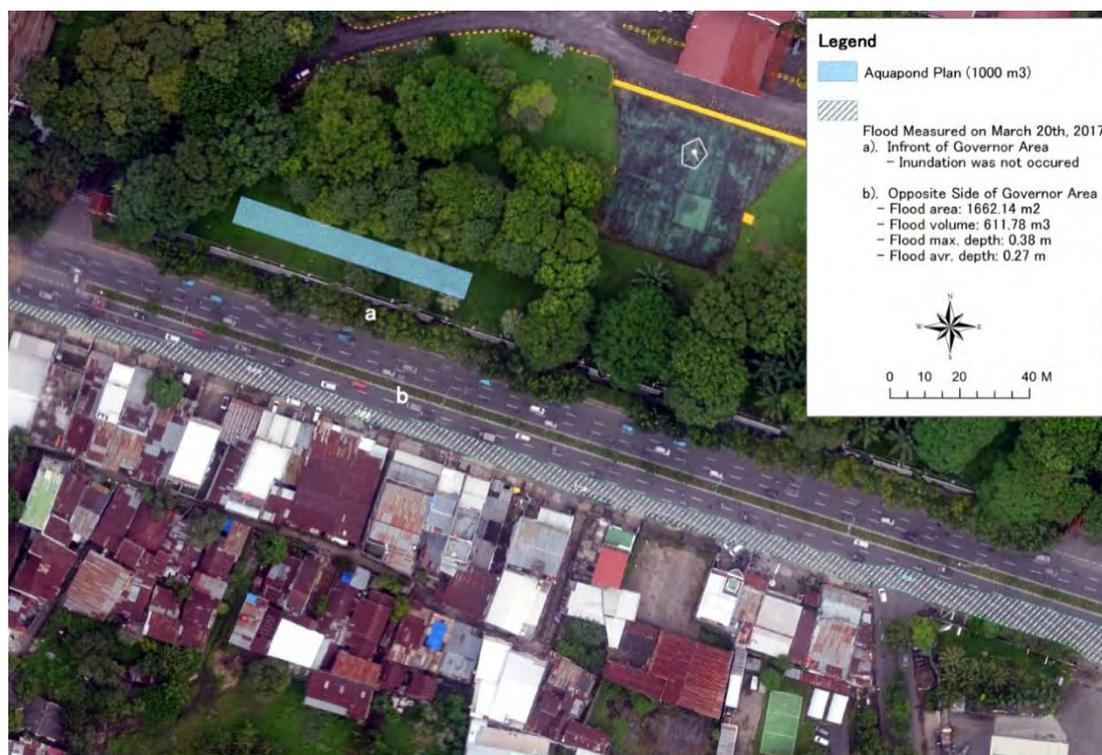
図 26 2017年3月20日、州知事公舎前道路の冠水面積・ポイント深さの測量
