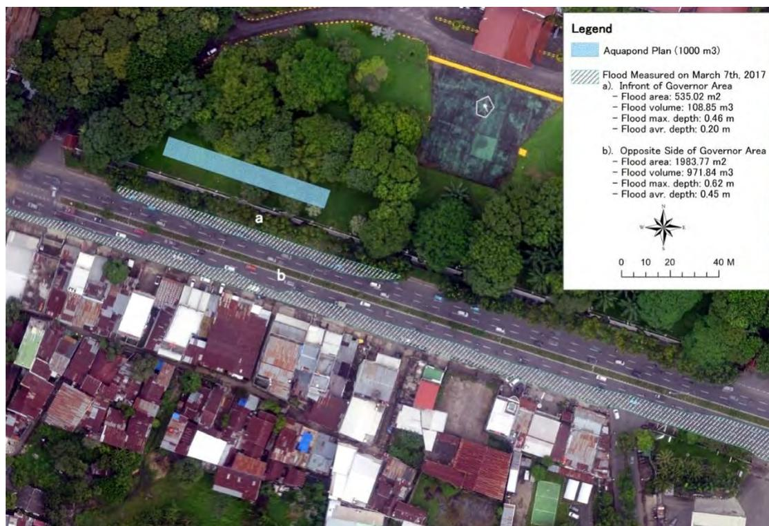
図 25 2017年3月7日、州知事公舎前道路の冠水面積・ポイント深さの測量
