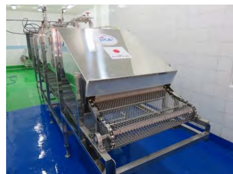
2016年11月 機材の設置及び試運転 (写真はステンレス製自動蒸機)
