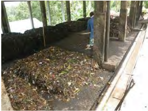
写真 2 Windrow Compost 方式によるコンポスト製造作業
