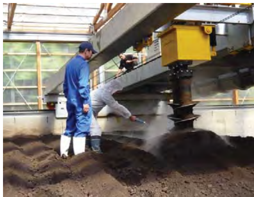
写真 17 攪拌中の計測（国内の事例）
