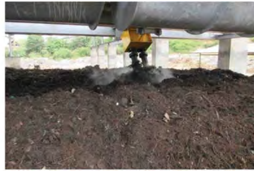
写真 23 RA-X 攪拌状況（左側：家庭ゴミ投入箇所 右側：高温好気性発酵箇所）
