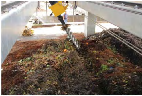
写真 23 RA-X 攪拌状況（左側：家庭ゴミ投入箇所 右側：高温好気性発酵箇所）
