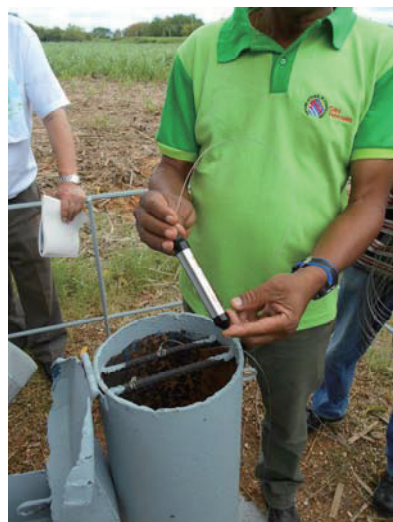
観測井 JICA-3 に設置した自動磁気水位計
