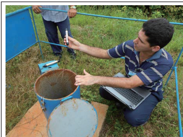
本プロジェクトで設置した観測井 JICA-1 での モニタリング
