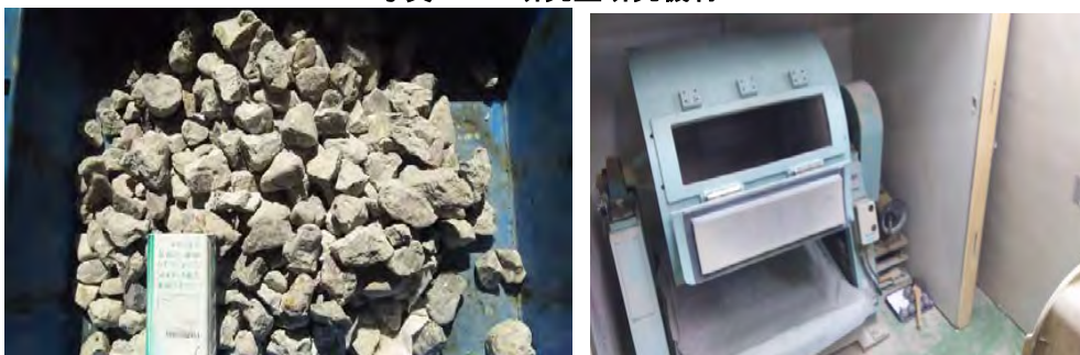
写真左：ロサンゼルス試験機（公益財団法人東京都道路整備保全公社）、 右：試験前の試料の状態
