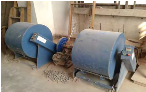
骨材強度測定機械（ロサンゼルス試験機）
