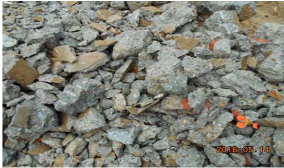
破碎後のコンクリート廃材
