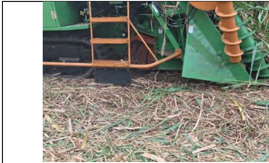
地下 5 センチまで刈取り可能な提案製品 (地上付近が最もキビの糖分が高い)
